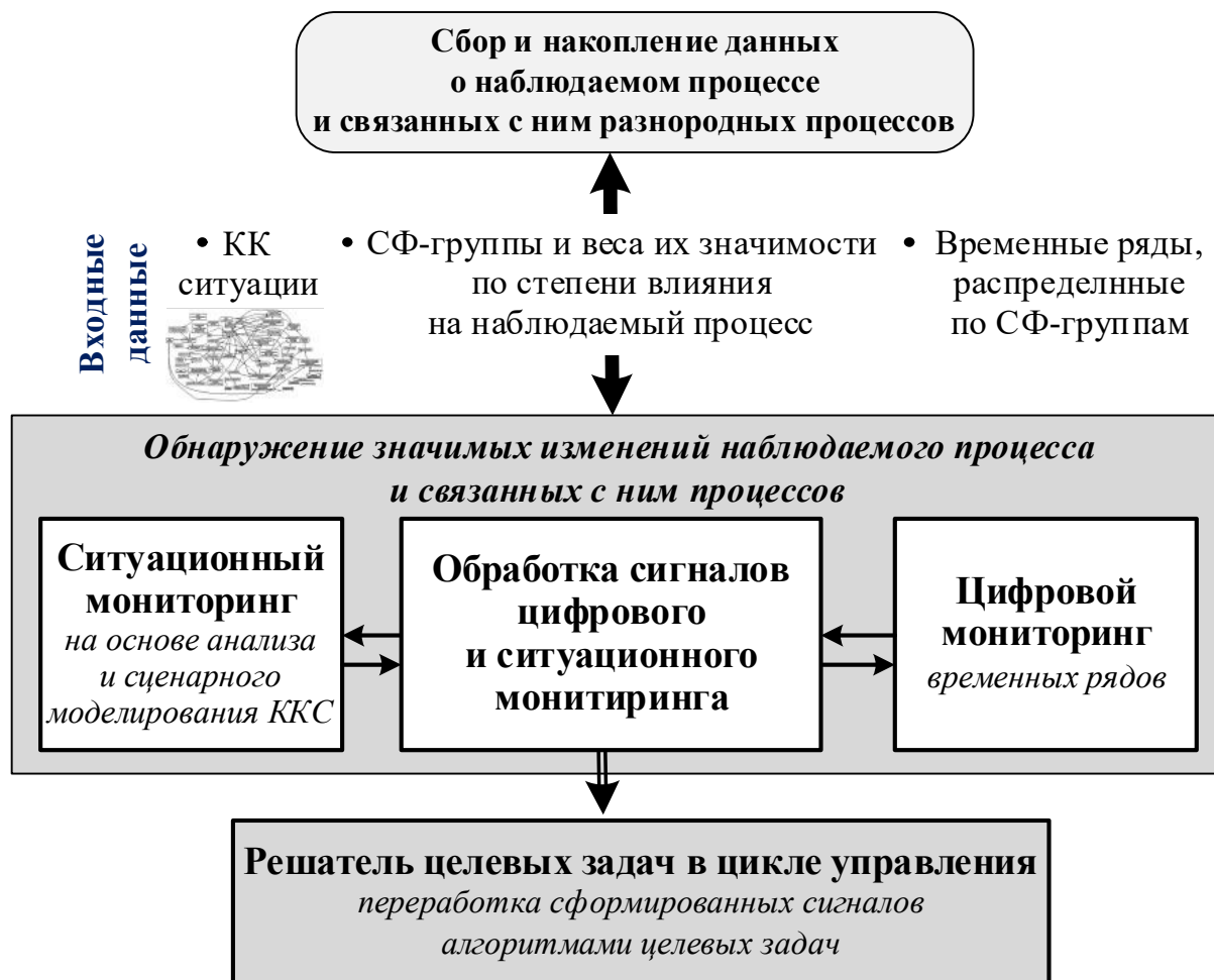
Рисунок 1 – Укрупненная схема мониторинга (на примере использования количественных методов анализа временных рядов)
