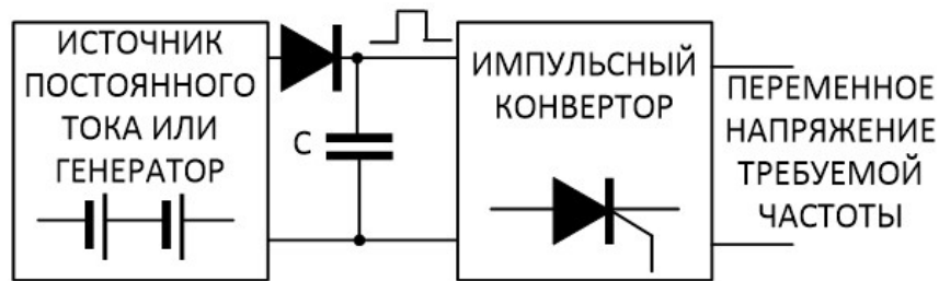
Рисунок 1 – Типовая структура преобразователя электрической энергии от источника постоянного тока (аккумулятора) или генератора переменного тока переменной частоты с использованием импульсного ключевого преобразователя
