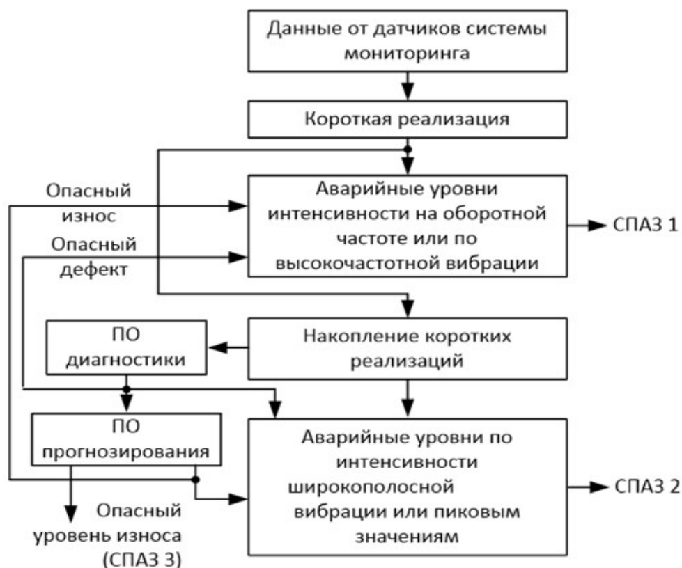
Рисунок 6 – Структура системы вибрационной противоаварийной защиты электромеханического оборудования
